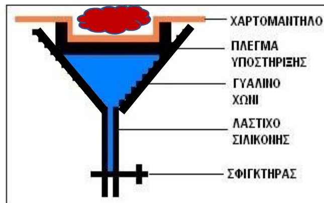
Εικόνα 2.4. Σχηματική αναπαράσταση της διάταξης συλλογής νηματωδών με τη μέθοδο Baermann.
