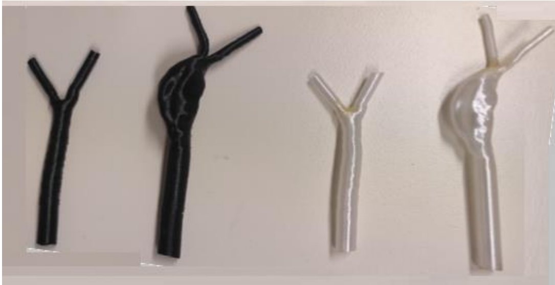
Εικόνα 30: Ζευγάρια δοκιμών (υγείους - παθολογικού) κατασκευασμένα από διαφορετικό υλικό.
