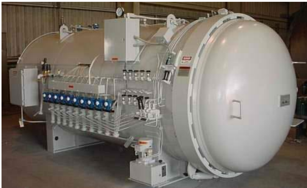
Εικόνα 2.17: Αυτόκλειστος Melco Steel Inc., California Azusa. [3]
