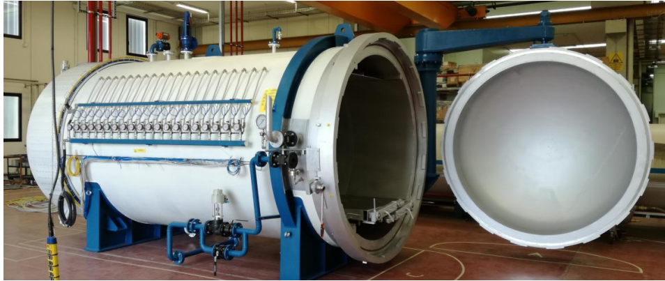
Εικόνα 2.16: Ο αυτόκλειστος φούρνος (autoclave) της Riba Composites. [3]
