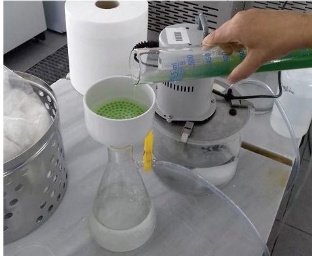
Εικόνα 16. Αντλία κενού και φίλτρο προκειμένου να συλλεχθεί η υγρή μάζα των νηματοειδών κυανοβακτηριακών μικροφυκών.
