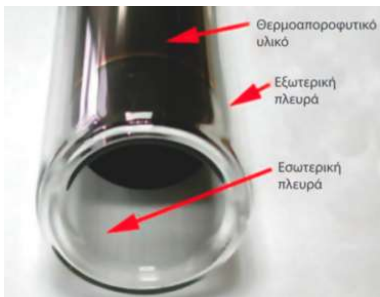
Σχήμα 2.8: Λεπτομέρεια από σωλήνα που χρησιμοποιείται στους συλλέκτες κενού. 45 (Πηγή: http://ape.chania.teicrete.gr )
