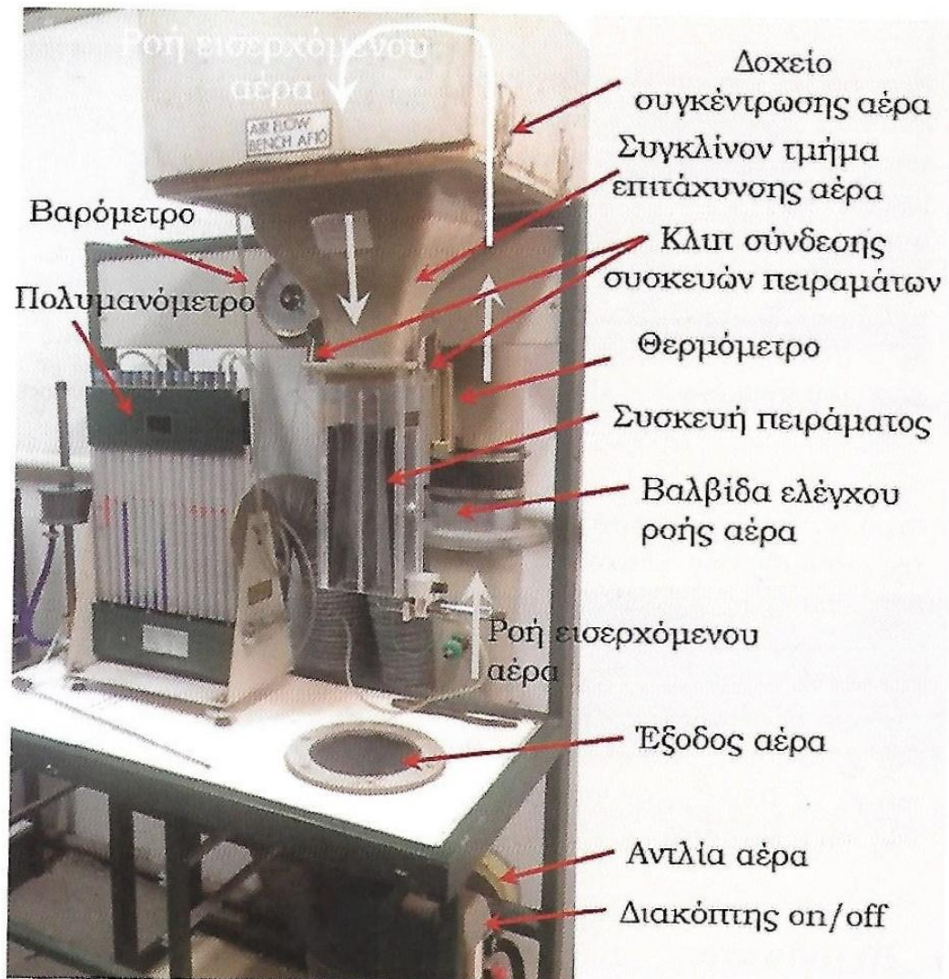
Σχήμα 5.1 Πάγκος ροής αέρα [1].
