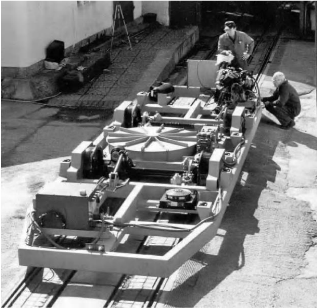
Εικόνα 2.6 Το Parry People Mover. Ο σφόνδυλος φαίνεται καθαρά στο μέσον του οχήματος [4].
