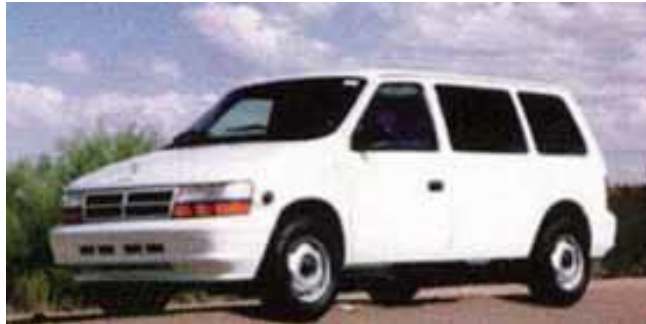
Εικόνα 1.7 Το ηλεκτρικό Dodge Caravan με μπαταρία μολύβδου-οξέως [2].
