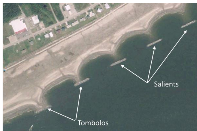
Εικόνα 8 - Σχηματισμοί salient και tombolo (Miller et al., 2016, Living Shorelines Engineering Guidelines)
