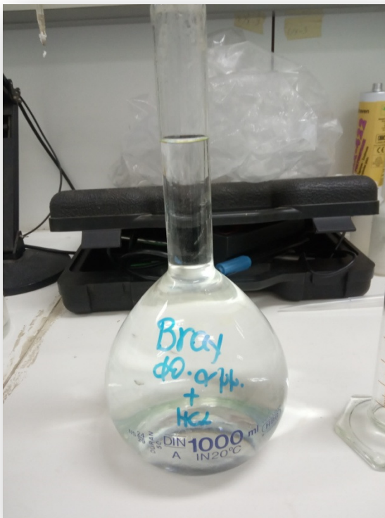
Εικόνα 25. 1ο μέρος εκχύλισης: Τοποθέτηση εκχυλίσματος χωρίς ακόμα την προσθήκη απιονισμένου νερού
