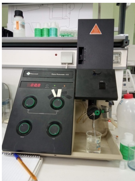
Εικόνα 35. Φλογοφωτόμετρο που μετρά K,Na,Ca
