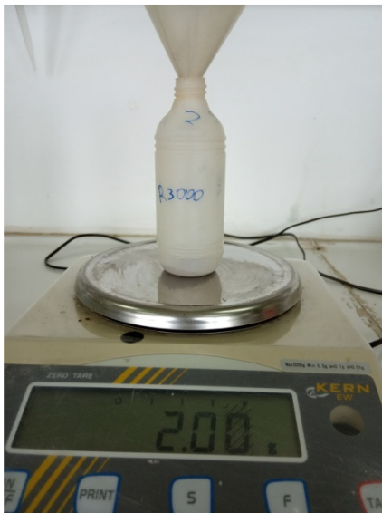
Εικόνα 22. Ζύγιση 2γρ. εδάφους στην απλή ζυγαριά Εικόνα 23. Ογκομετρικός σωλήνας των 100ml
