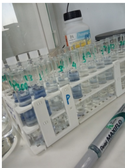
Εικόνα 34. Δείγματα που μετρήθηκαν στο φασματοφωτόμετρο με βάση την LowRange-1.
