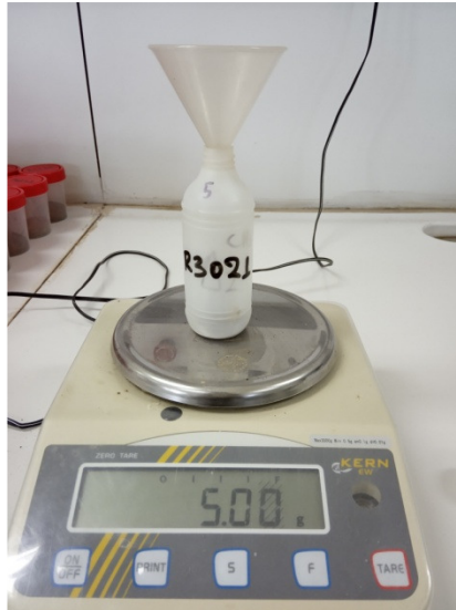
Εικόνα 29. Ζύγιση εδάφους 5γρ. στην ζυγαριά
