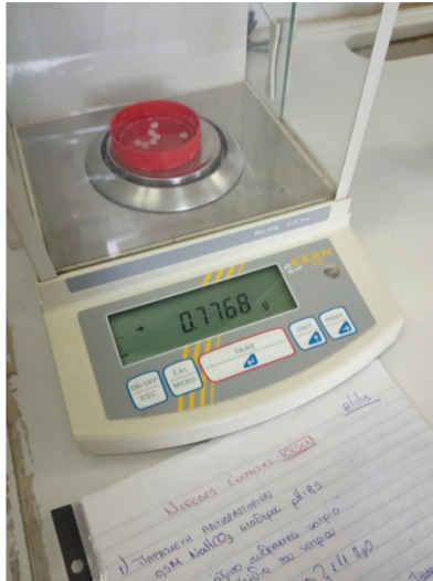
Εικόνα 19. Ζύγιση NaOH στη ζυγαριά ακριβείας
