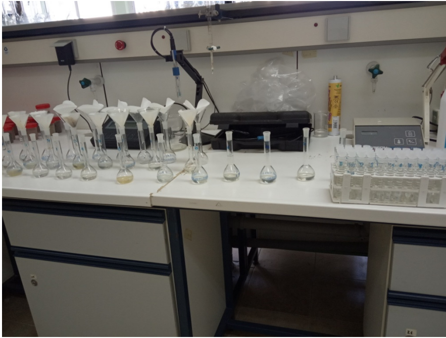
Εικόνα 25. 1ο μέρος εκχύλισης: Τοποθέτηση εκχυλίσματος χωρίς ακόμα την προσθήκη απιονισμένου νερού
