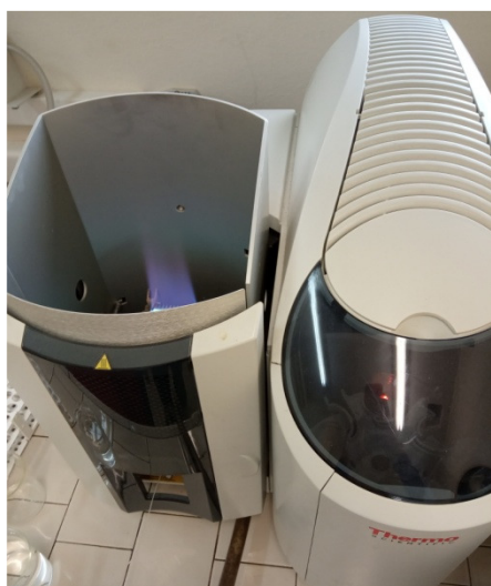
Εικόνα 36. Φλογοφωτόμετρο όπου μετρήθηκε το Mg. Εικόνα 37. Οθόνη όπου απεικονίζεται απευθείας η μέτρηση του Mg.
