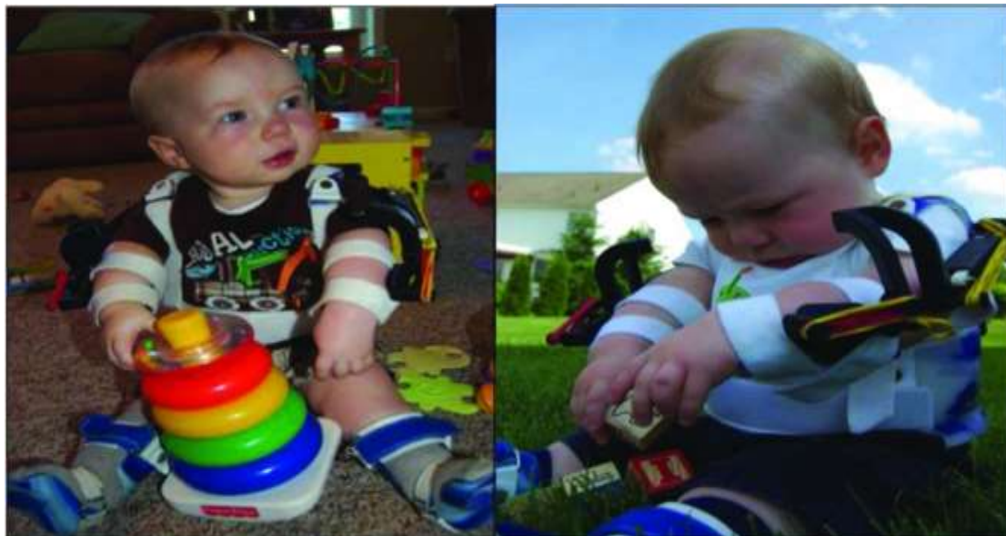
Εικόνα 14. Το τρισδιάστατο τυπωμένο Wilmington Robotic Exoskeleton (WREX) σε ένα βρέφος (Lobo et. al., 2015)
