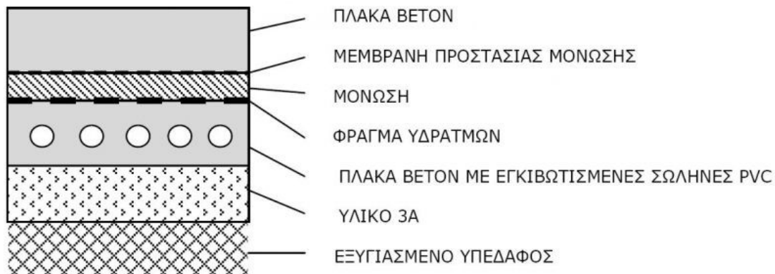
Εικόνα 2.6 :Υλικά κατασκευής δαπέδου(Πηγή: http://www.cold.org.gr , Ένωση Ελληνικών Βιομηχανιών Ψύχους)
