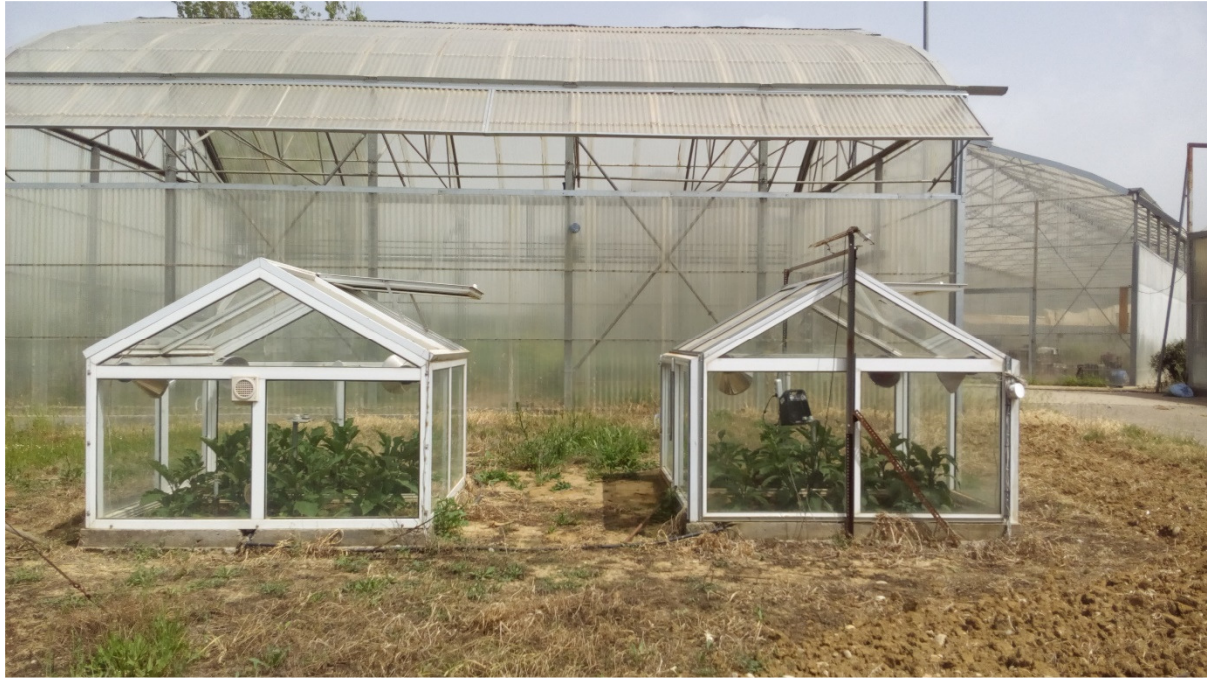
Εικόνα 3α. Τα πειραματικά θερμοκήπια, εξοπλισμένα με σύστημα υπέρυθρη θέρμανσης (αριστερά) και συμβατικής θέρμανσης (δεξιά).
