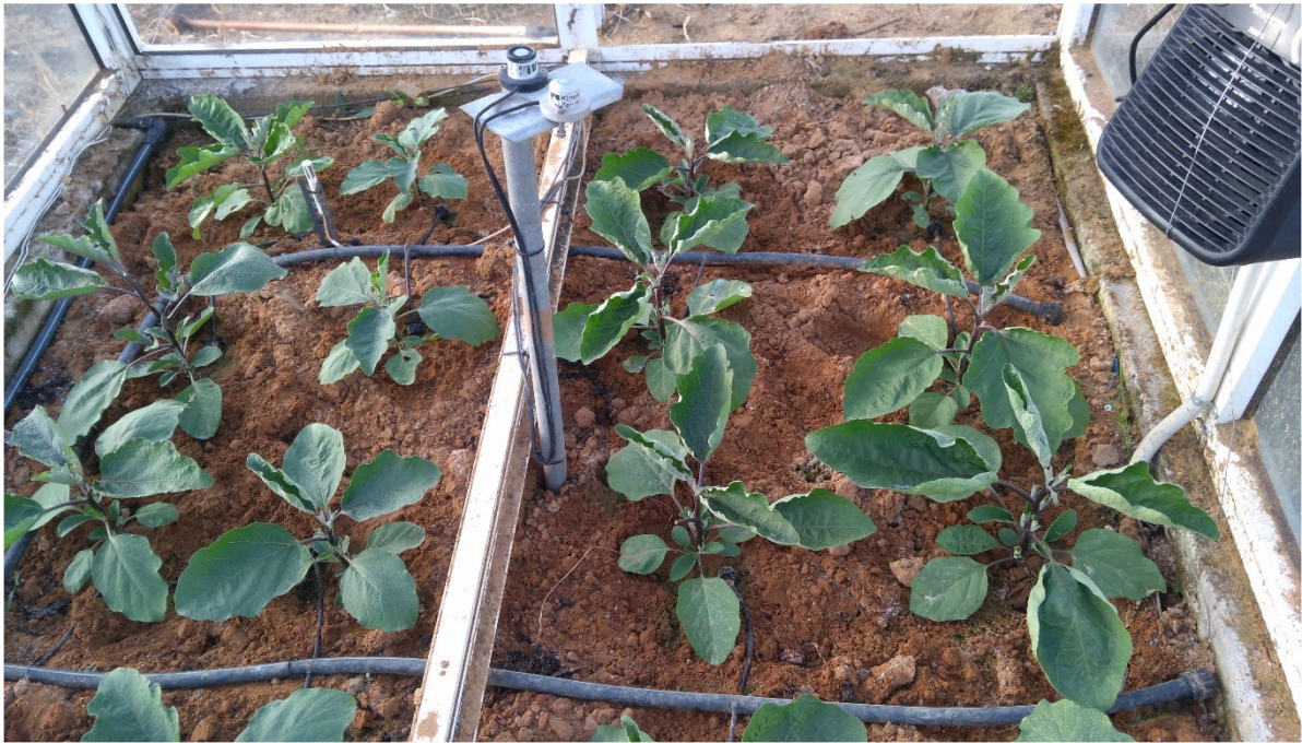
Εικόνα 5α. Νεαρά φυτά μελιτζάνας στο συμβατικό θερμοκήπιο. Διακρίνονται οι αισθητήρες Θερμοκρασίας-υγρασίας, ηλιακής ακτινοβολίας και PAR
