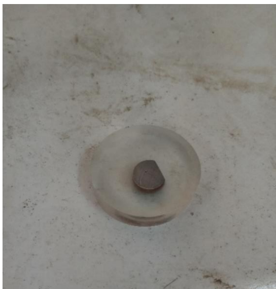
Σχ.5.17 Εγκυβοτισμένο δοκίμιο
