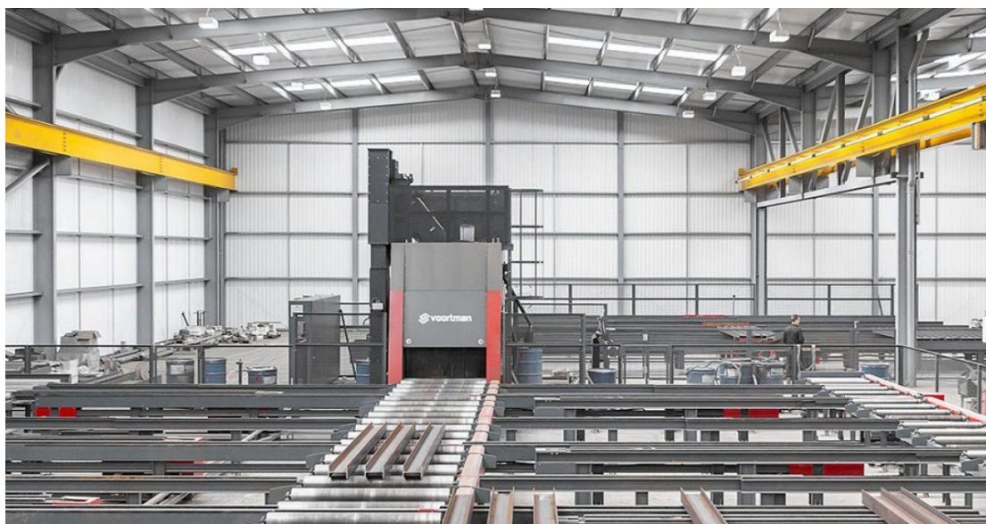
Σχ.5.1 Μηχάνημα αμμοβολής VOORTMAN με ενσωμάτωση πολλαπλών συστημάτων[7]
