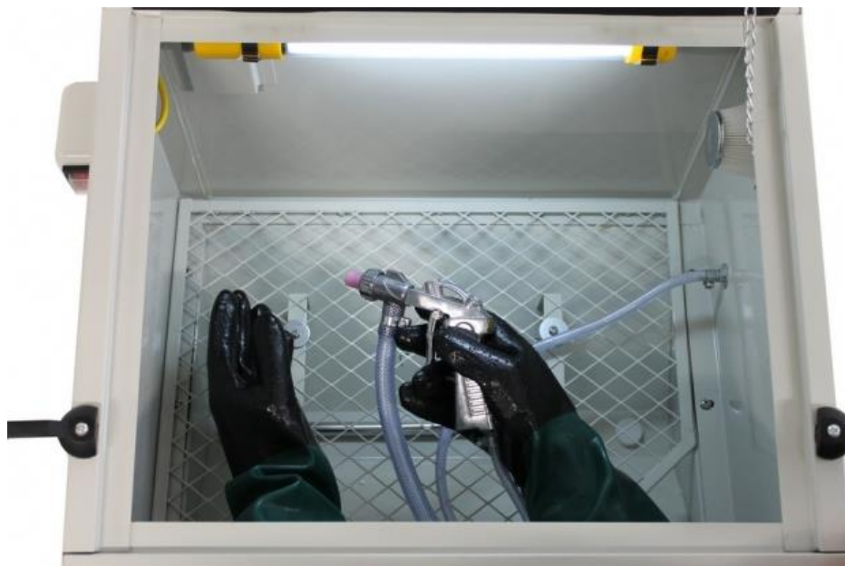
Σχ.5.10 Εσωτερικό καμπίνας αμμοβολής [9]
