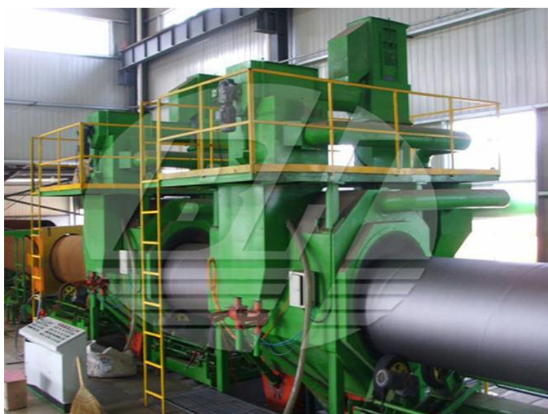
Σχ.4.15 Μηχανή αμμοβολής μεταλλικών σωλήνων [3]
