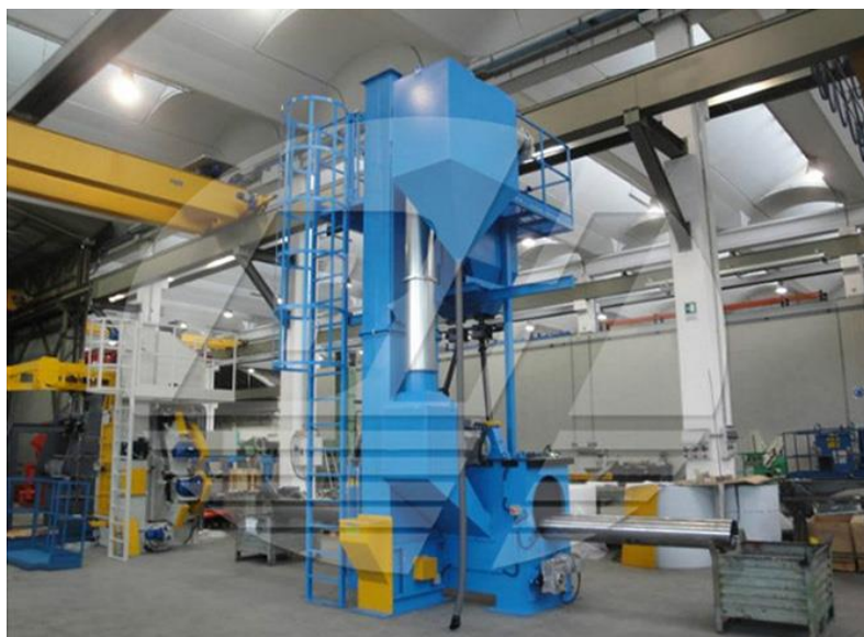
Σχ.4.14 Μηχανή αμμοβολής μεταλλικών σωλήνων [3]
