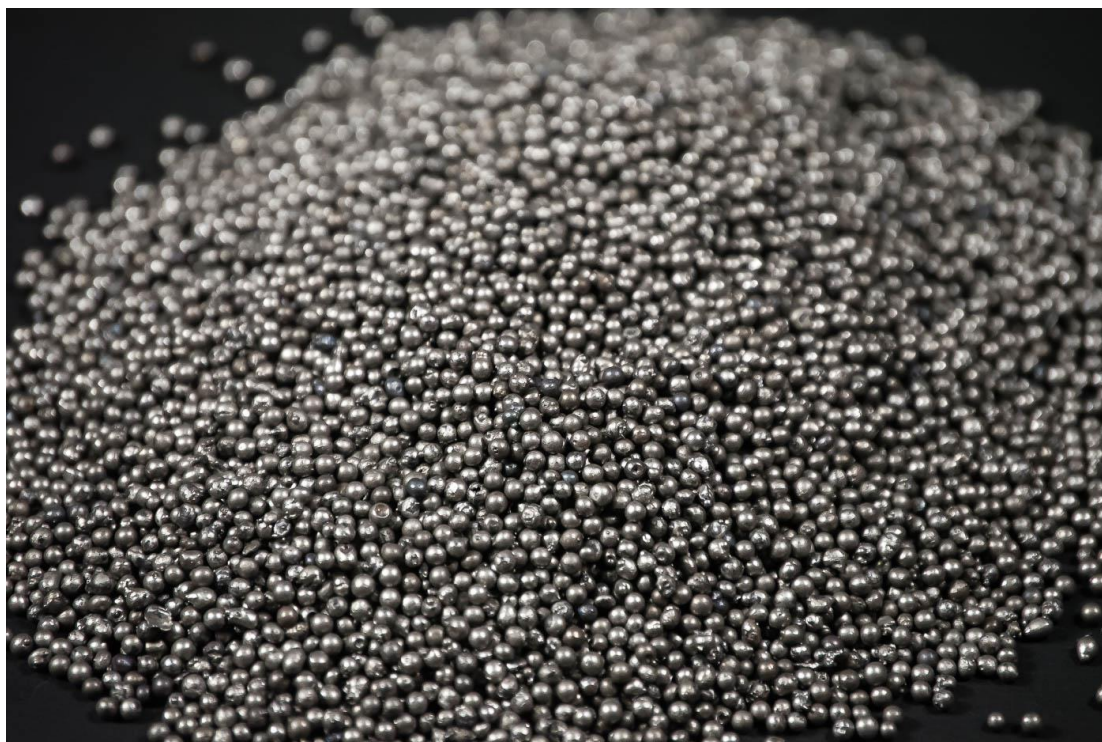
Σχ.5.4 Αποξεστικό μέσο μηχανήματος(steel shot s390)
