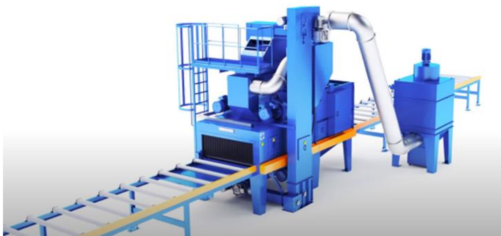
Σχ.4.8 Σχέδιο μηχανής αμμοβολής πλακών χάλυβα[3]
