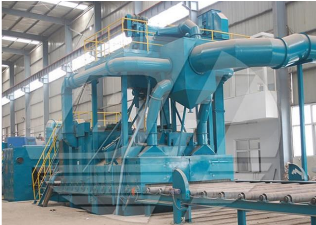
Σχ.4.5 Μηχανή Αμμοβολής πλακών χάλυβα[3]
