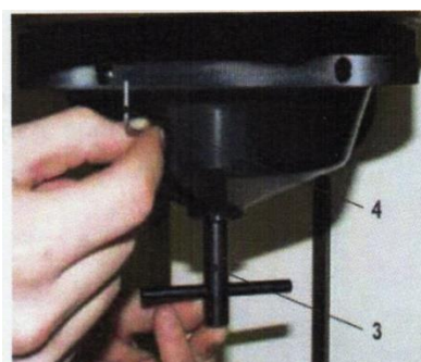
Σχ.5.16 Τοποθέτηση διεισδητή[10]
