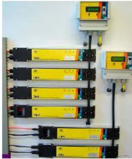
Εικόνα 3.3.5 Αντιστροφείς για ενσωμάτωση σε Φ/Β πάνελ
