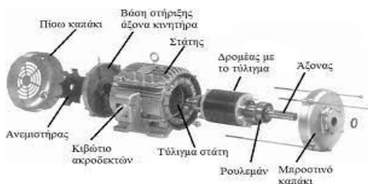
Εικόνα 22: Δομή ασύγχρονου κινητήρα βραχυκυκλωμένου δρομέα
