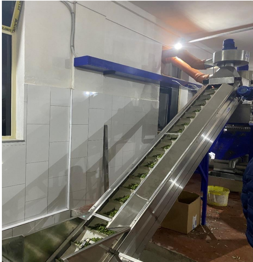
Εικόνα 8: Μεταφορική ταινία – αναβατόριο
