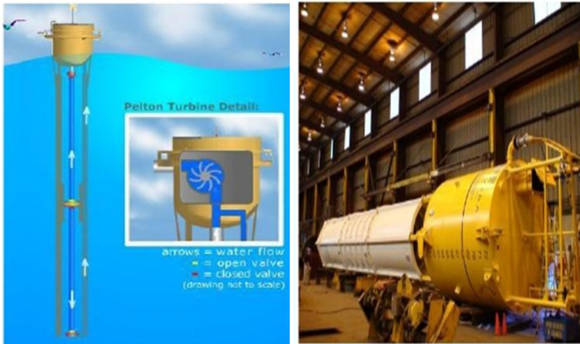
Εικόνα 74: Η λειτουργία του AquaBuoy και η προετοιμασία καθελκυσμού.
