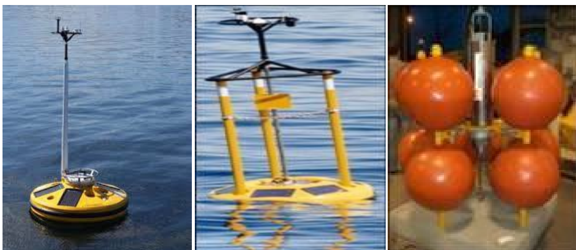
Εικόνα 44: Οι πλωτοί σταθμοί Wavescan , Seawatch και Seawatch Deep Sea Module (SDSM) .
