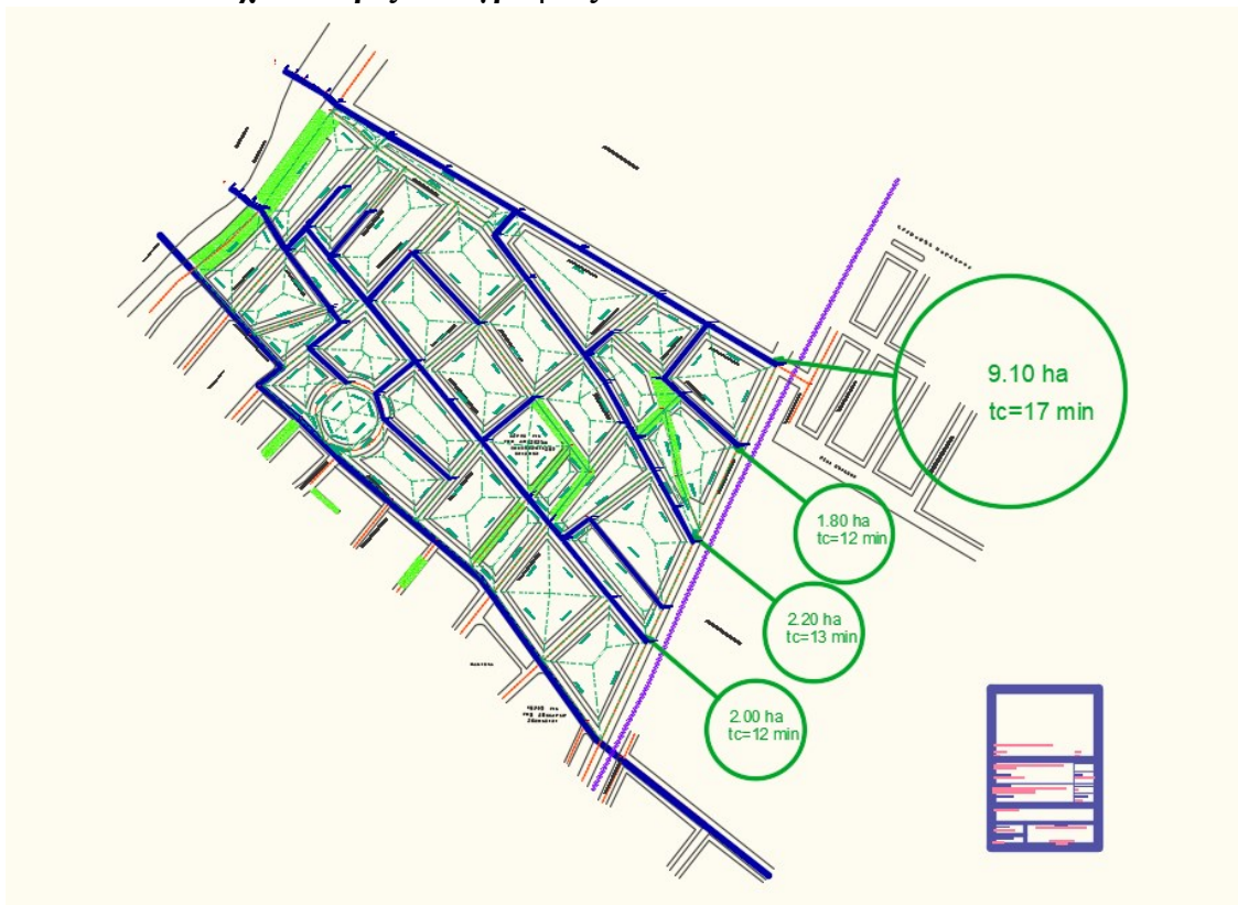
Εικόνα 16: Οριζοντιογραφία του τμήματος δικτύου αποχέτευσης ομβρίων.
