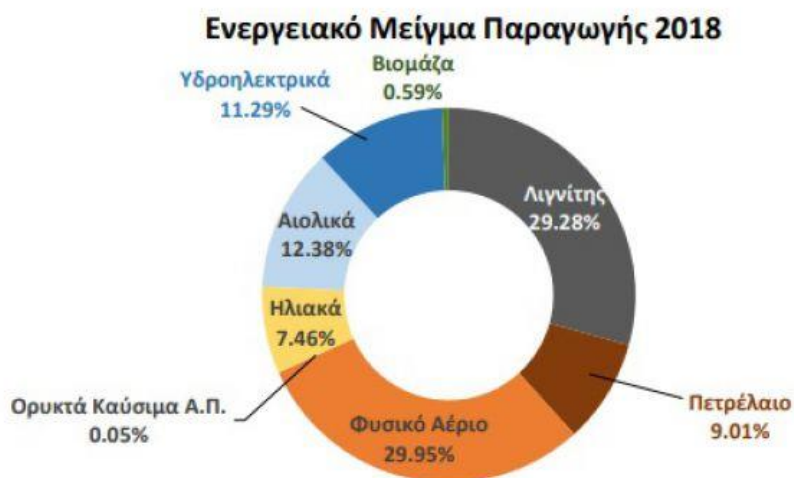
Εικόνα 1.2. Εγχώρια παραγωγή ενέργειας ανά μορφή καυσίμου
