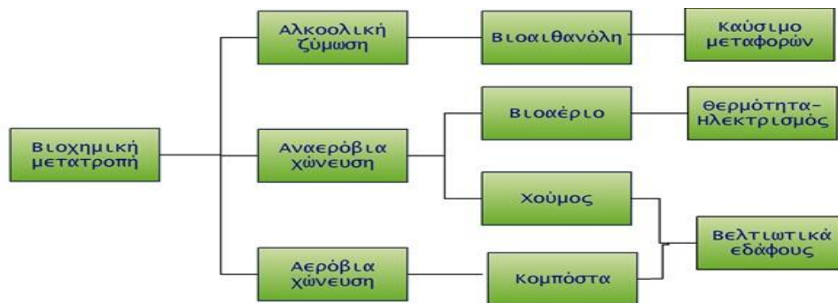
Σχήμα 4.1. Παραγωγή υγρών καυσίμων με βιοχημική μετατροπή βιομάζας
