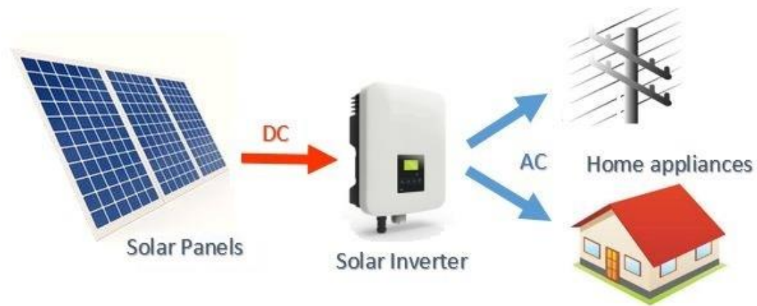
Εικόνα 1.24.: Χρήση του αντιστροφέα σε φωτοβολταϊκά συστήματα. [21]
