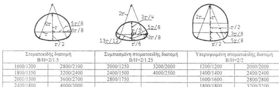
Εικόνα 20: Στοματοειδής διατομή αγωγού [Διαδίκτυο 20]
