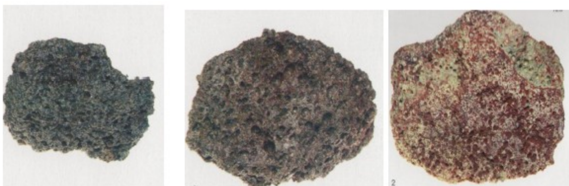
Πετρώματα με πορώδη υφή, κατάλληλα για μολόπετρες.
