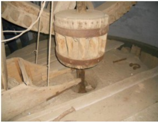
Η ανέμη ή φανάρι με το βασιλικό σίδερο (επάνω) Η αλευροκασέλα με την έξοδο του αλευριού (δεξιά)
