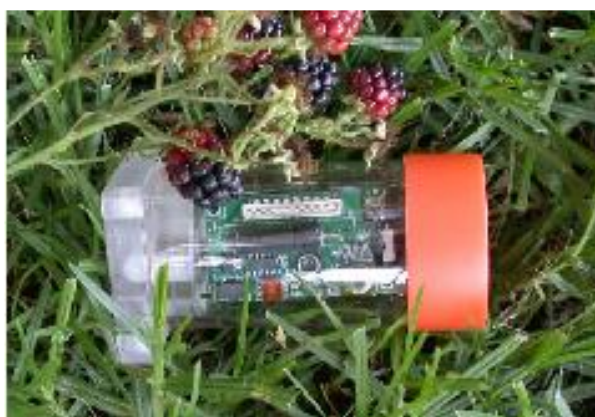
Σχήμα 1.15: Κόμβος – Αισθητήρας για παρακολούθηση θερμοκρασίας, υγρασίας κτλ.
